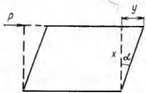
Рис. VII.1. Схематическое изображение деформации сдвига
