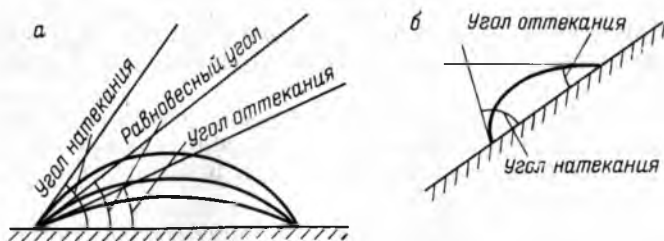
Рис. II.20. Статические углы натекания и оттекания, формирующиеся при изменении количества жидкости в капле ( а ) и угла наклона поверхности ( б )
