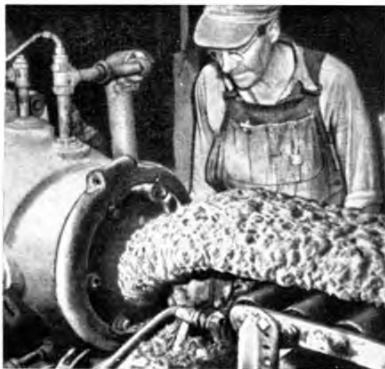
Р и с. 200. Сырой каучук размягчают перед изготовлением шин.
