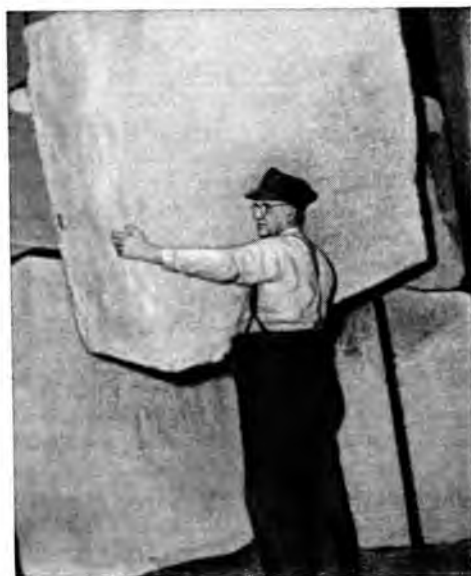
Рис. 179. Формальдегид используется при получении синтетических пенопластов, обладающих чрезвычайно малым весом (их называют «бакелитовой пеной»).
