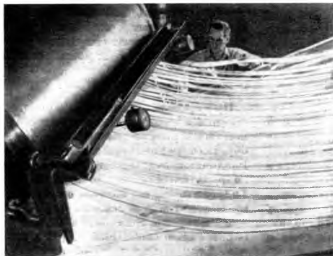
Р и с. 213. Ленты из мыла, которые используются для приготовления мыльной стружки или брусков мыла.
