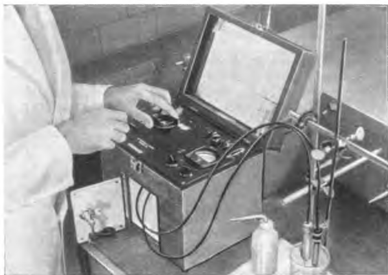
Р и с. 120. Распространенным в лаборатории прибором является рН-метр. Этот прибор имеет выносные электроды.
