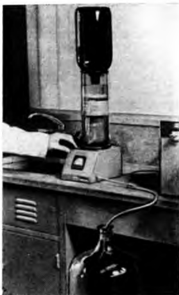
Р и с. 98. Лабораторный аппарат для получения деионизированной воды.
