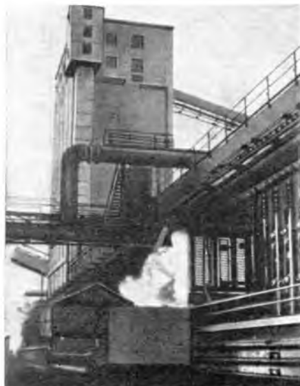
Р и с. 128. Горящий уголь в определенный момент гасят и получают кокс.
