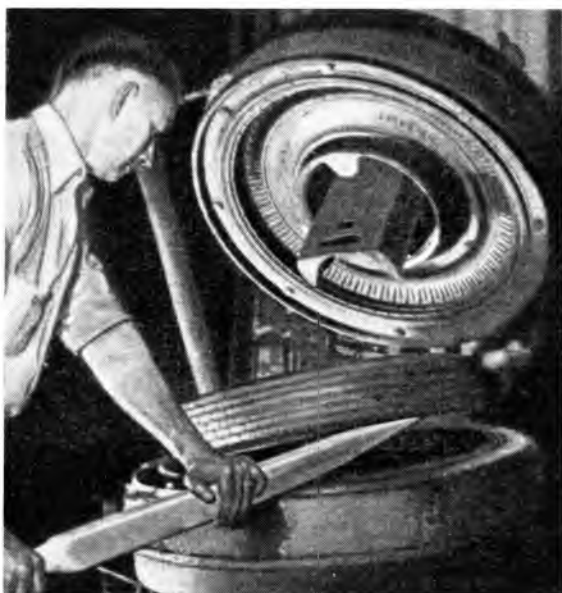
Р и с. 201. Готовая шина вынимается из формы после вулканизации.
