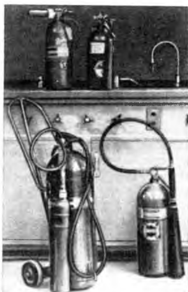
Р и с. 67. Типы огнетушителей с углекислым газом, применяемых в лабораториях.
