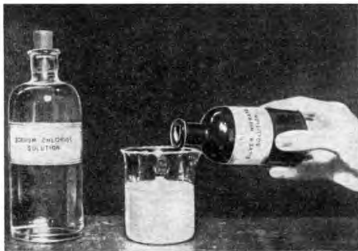
Рис. 117. При приливании раствора нитрата серебра к раствору хлорида натрия выпадает белый осадок. Эта реакция используется для обнаружения хлорид-ионов.
