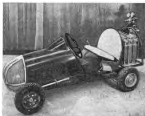
Р и с. 71. Экспериментальный автомобиль, приводимый в движение кислородным топливным элементом.
