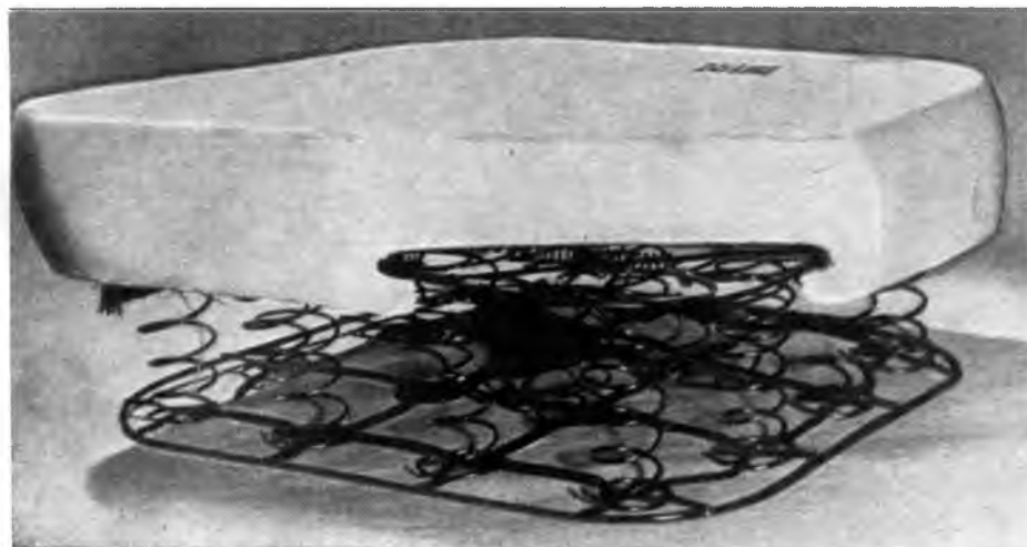
Р и с. 188. Мягкая набивка для автомобильного сиденья, изготовленная из одного отформованного блока уретанового пенопласта.
