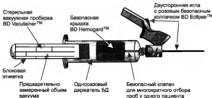
Рис. 38. Устройство системы BD VACUTAINER
