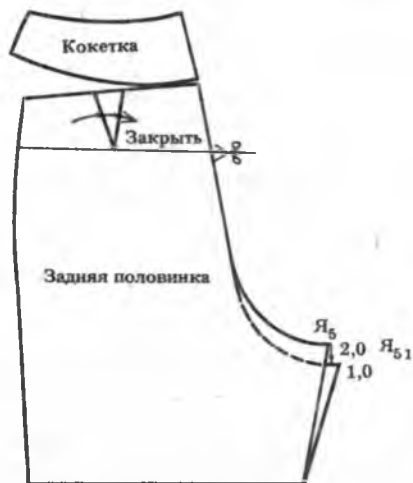
Рис. 11. Так моделируется кокетка
